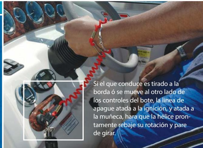
Si el que conduce es tirado a la borda ó se mueve al otro lado de los controles del bote, la línea de apague atada a la ignición, y atada a la muñeca, hará que la hélice prontamente rebaje su rotación y pare de girar.
